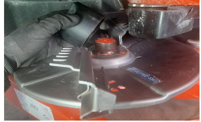
Kuva 8. Lautasen hattumutteri auki. Lautanen on nyt nostettavissa pois (Ketomäki).
