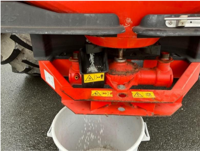
Kuva 7. Saavi kiertokoekaukalona (Ruukonen).
