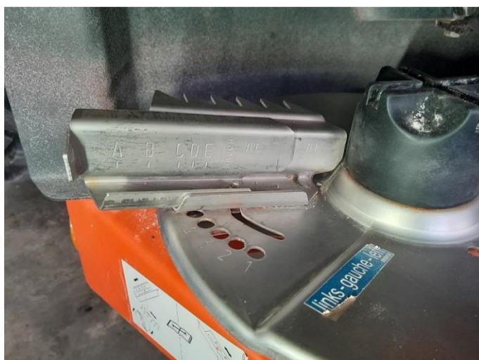
Kuva 5. Rauch-lautaslevittimen siivekkeiden säätöasennot (Ketomäki)
