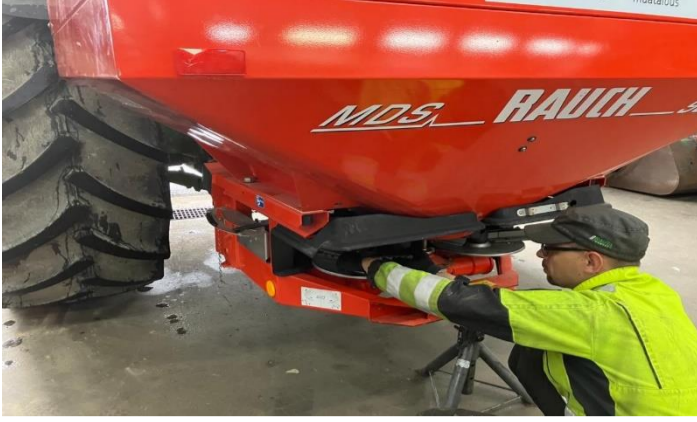
Kuva 7. Lautasen irrotus. Huomaa koneen putoamisen varmistus (Ruukonen).
