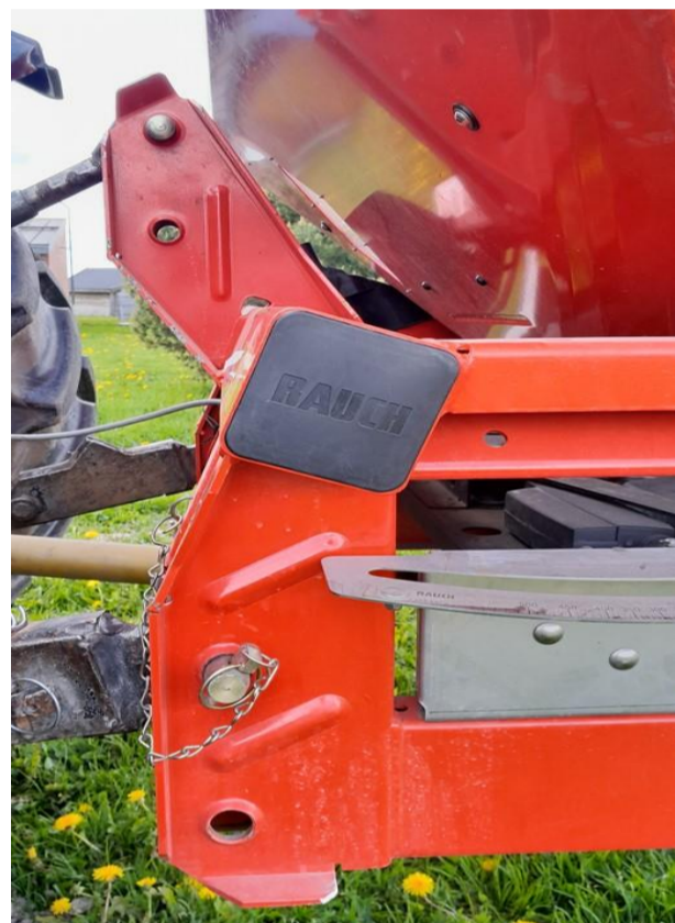
Kuva 1. Rauch-lautaslevittimen kiinnityspisteet (Ketomäki).
