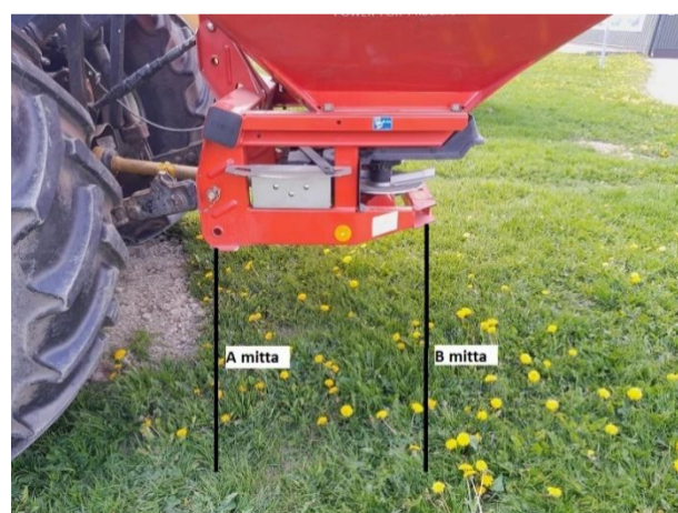
Kuva 2. Rauch-lautaslevittimen työkorkeuden mittauspisteet (Ketomäki).
